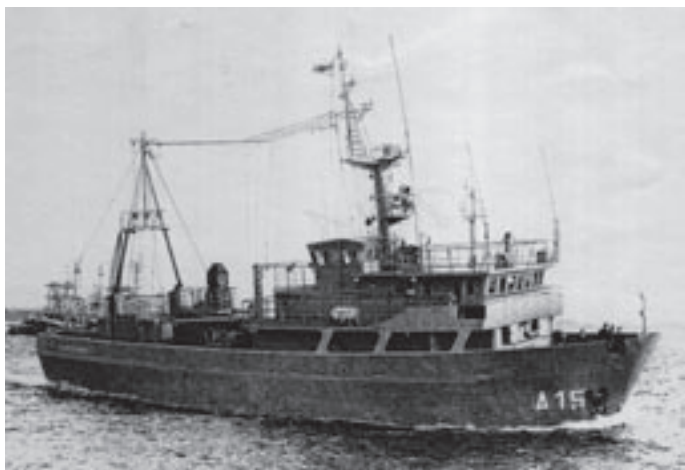
Das Flugsicherungsschiff „Hugo Eckener“ der DDR-Volksmarine entstand aus einem Heckfänger Typ „Havanna“ und ging 1971 in Dienst. Foto: Archiv
